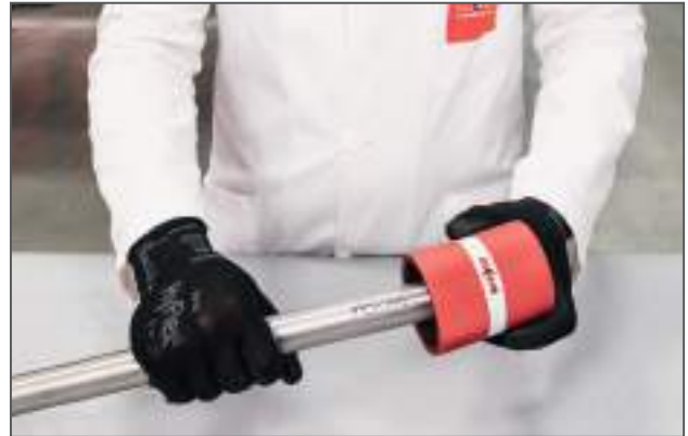
Sbavatura del tubo / Deburring the pipe
