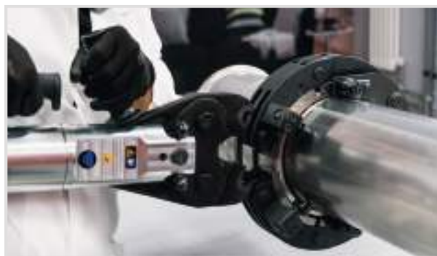
Assemblaggio pressatura n°1 / Press assembly phase 1
